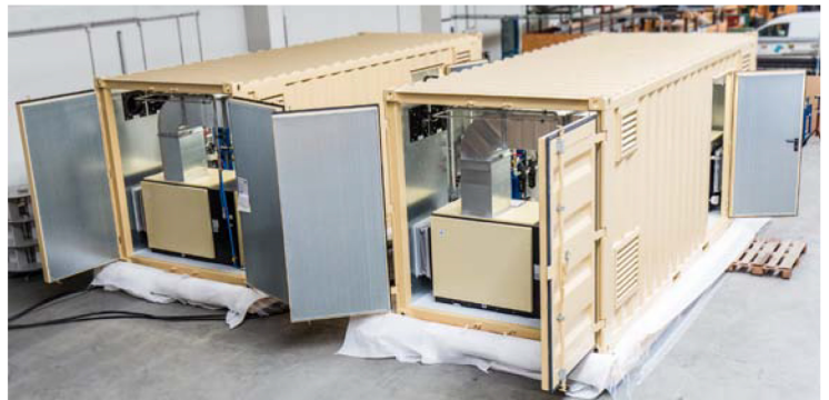
Fertigung Druckluftstation im Container
